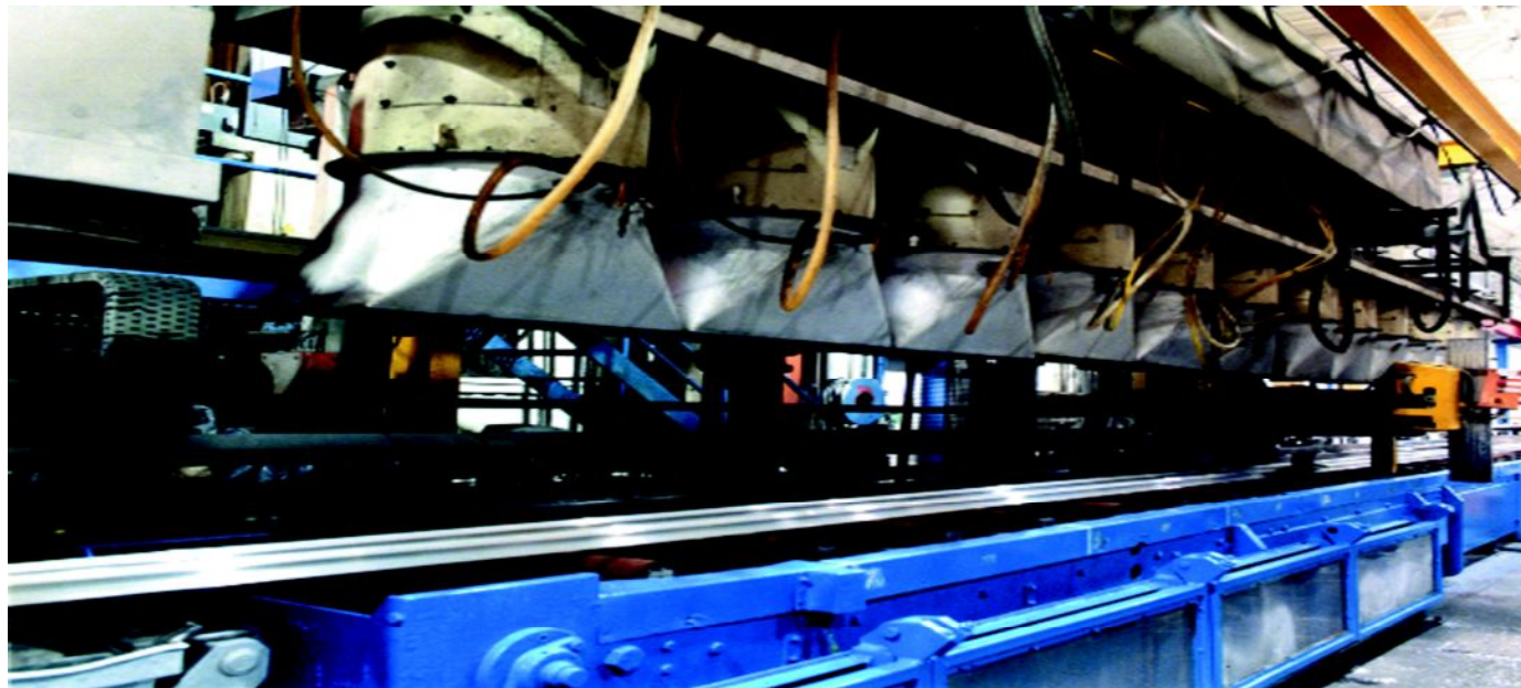
代表的な押出プロセスでの空冷式クエンチシステム
